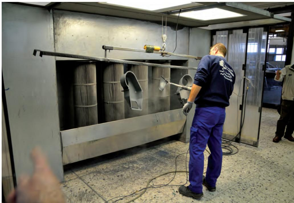
**Nach dem Sandstrahlen erfolgt der Auftrag der neuen Grundierung. Das Pulver haftet durch statische Aufladung und lässt sich bis zum Einbrennen wie eine Staubschicht trocken abwischen.**
